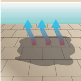
Lassen Sie die behandelte Oberfläche 24 Stunden trocknen. Die Imprägnierung sollte alle 3–5 Jahre wiederholt werden.
